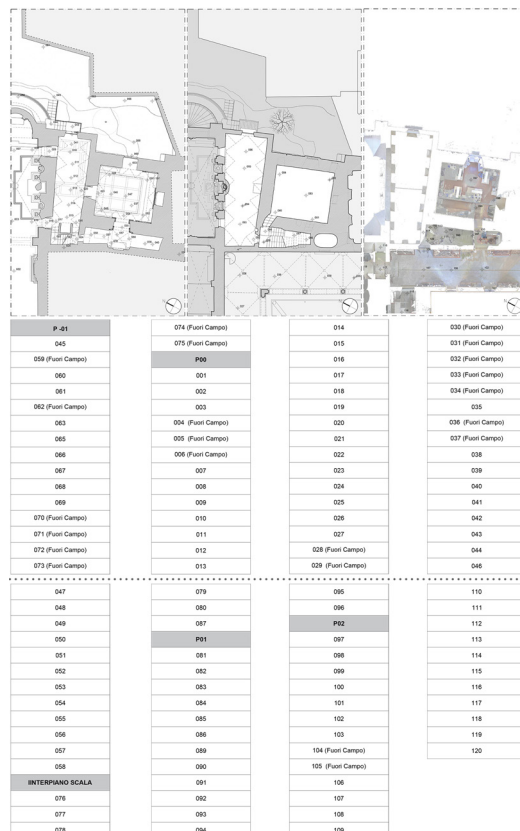
Fig. 03. Piante in cad estrapolate dalla nuvola di punti densa e posizioni delle stazioni di presa. In tabella la numerazione progressiva delle stazioni divise per piani di calpestio e se o meno fuori campo (Elaborazione dell'autore).
