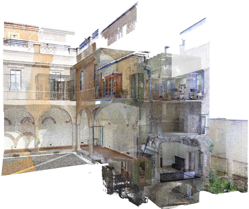
Fig. 08. Vista prospettica da point cloud del blocco chiostro/sacrestia/uffici di Ingegneria de La Sapienza. Piano sezione gestito in ReCap (Elaborazione dell'autore).
